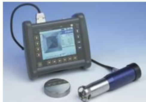
Esta técnica permite a realização de testes sem a necessidade de calibrações adicionais nos diferentes materiais, uma vez que faz as medições nas diagonais opticamente e não de forma indireta, possibilitando também medições em objetos finos e pequenos, como também em revestimentos.
