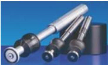
Existem sondas de rebote distintas a serem definidas de acordo com o impacto desejado (N/mm) ou a indentação requerida, variando o tamanho e material do esfera do torpedo.
